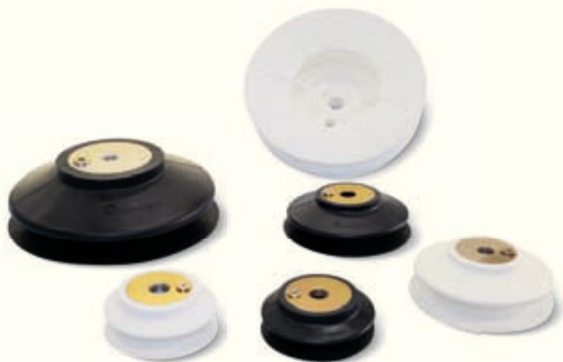
La principale caratteristica delle ventose a soffietto è quella di accartocciarsi rapidamente durante la presa sollevando, in tal modo, il carico di qualche centimetro, indipendentemente dai movimenti dell'automatismo; questo rapido movimento, impedisce al carico sottostante di rimanere attaccato a quello sollevato.
