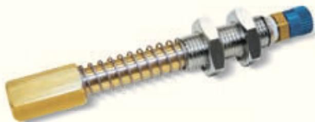
Oltre ad avere tutte le caratteristiche tecniche dei portaventose mini, hanno in più una valvola autoescludente integrata. La valvola autoescludente ha la funzione di chiudere automaticamente l'aspirazione, quando la ventosa non appoggia sulla superficie del carico da prelevare, oppure, quando la presa è difettosa o in presenza di una notevole traspirazione, evitando in tal modo, l'abbassamento del grado di vuoto sulle rimanenti ventose dell'impianto, regolarmente in presa col carico.
