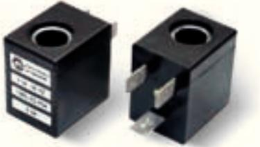
Le bobine elettriche sono standard, interamente plastificate in resina sintetica, esecuzione stagna, classe di isolamento F (fino a 155 °C) a norme VDE, con connessioni elettriche a tre terminali di 6,3 mm, per connettore a norme EN 175301-803 (ex DIN 43650).
