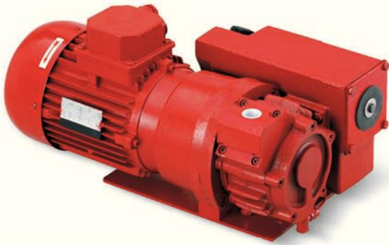
Le pompe per vuoto della serie MV sono monostadio, a palette rotative e con lubrificazione a bagno d'olio con riciclo. Le pompe sono azionate da un motore elettrico standard, accoppiato tramite un giunto di trasmissione elastico. Una ventola centrifuga, calettata sull'albero delle pompe, garantisce un adeguato flusso d'aria per l'ottimale raffreddamento del corpo pompa (raffreddamento superficiale forzato).
