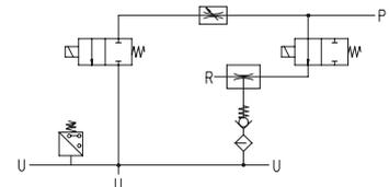
P=CONNESSIONE ARIA COMPRESSA    R=SCARICO    U=CONNESSIONE VUOTO
