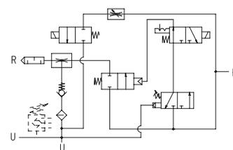
P=CONNESSIONE ARIA COMPRESSA    R=SCARICO ARIA    U=CONNESSIONE VUOTO
