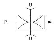
P=CONNESSIONE ARIA COMPRESSA    R=SCARICO ARIA    U=CONNESSIONE VUOTO
