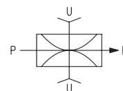
P=CONNESSIONE ARIA COMPRESSA    R=SCARICO ARIA    U=CONNESSIONE VUOTO
