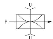
P=CONNESSIONE ARIA COMPRESSA R=SCARICO ARIA U=CONNESSIONE VUOTO
