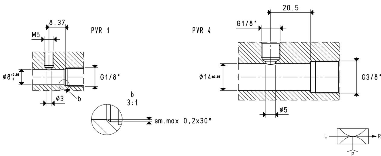
P=CONNESSIONE ARIA COMPRESSA R=SCARICO U=CONNESSIONE VUOTO
