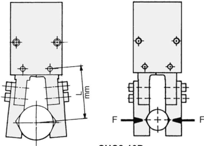
A força de retenção indicada nas tabelas representa a força de retenção de um dedo quando todos os dedos da garra estão em contato com a peça.
